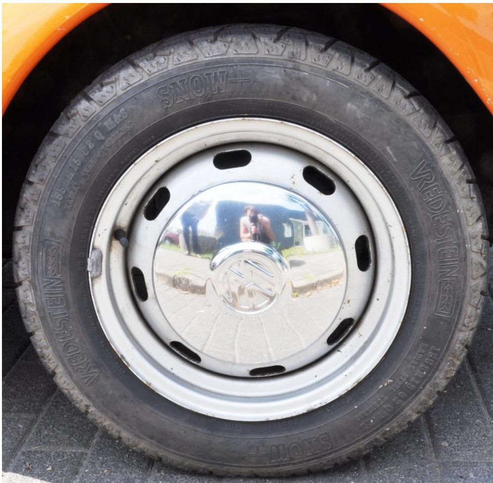
verkehrssichere Bereifung 155 SR 15 82Q M+S auf Stahlfelgen mit Radkappen
